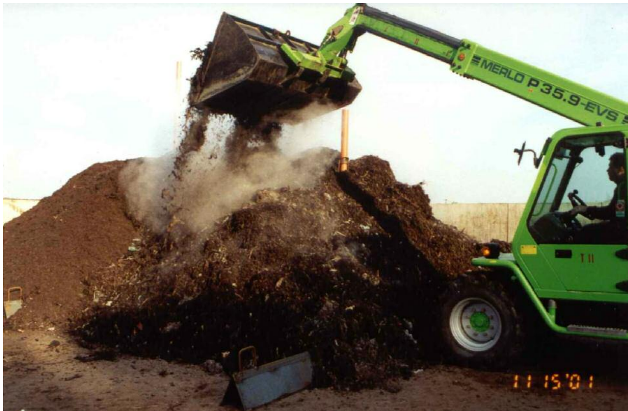
Abbildung 2 Mietenaufsetzen mit einem Teleskoplader
